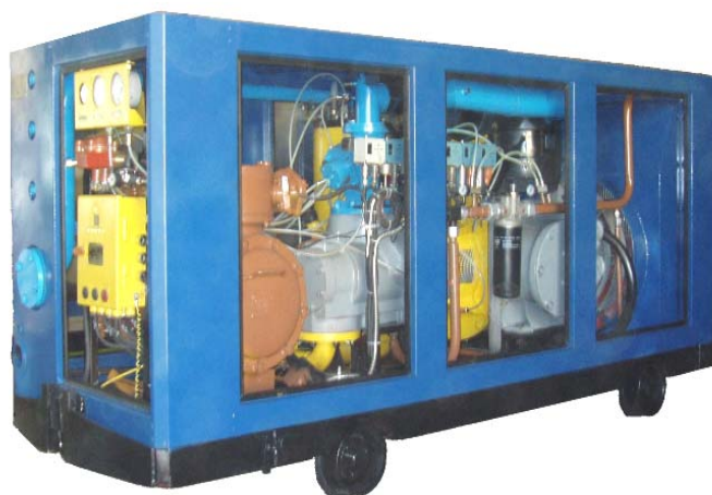
Рисунок 10 - Шахтная винтовая компрессорная установка УКВШ-10/7 А У2 с электрической системой защиты
