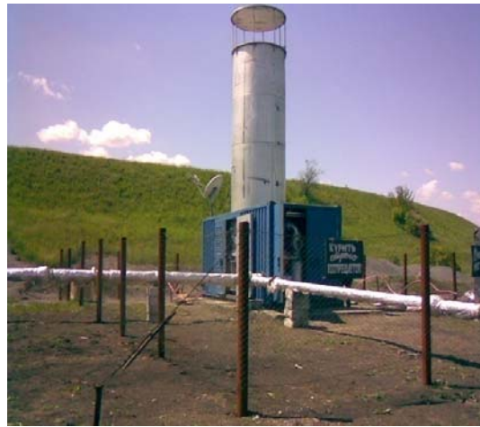
Рисунок 1 - Схема и внешний вид установки для дегазации угольных пластов, утилизации шахтного метана типа УКГ- 5/8.
