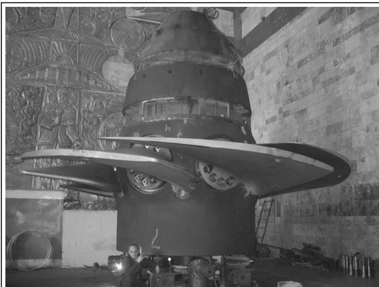
Рис. 3. Рабочее колесо Шамкирской ГЭС, Азербайджан
