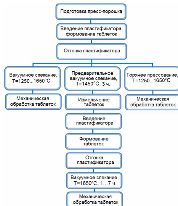
Рис. 1. Схемы изготовления таблеток гафната диспрозия
