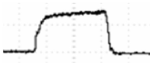
Рис. 2. Осциллограмма тока пучка ионов гелия из ПОС-4 с энергией 4 МэВ
