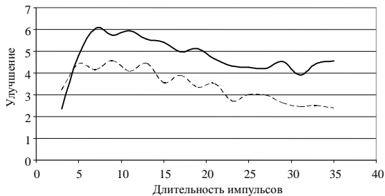
Рис. 6. Зависимость параметра «улучшение» (11) от длительности сигнальных импульсов, \sigma_{inp}^2=0,3 , P=30\% : --- BLW; ——— предлагаемый метод
