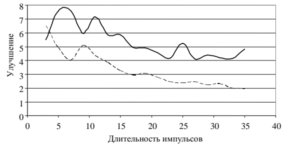
Рис. 3. Зависимость параметра «улучшение» (11) от длительности сигнальных импульсов, \bar{\sigma}_{inp}^2=0,5 : --- BLW; — предлагаемый метод
