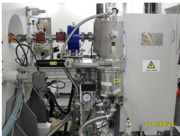
Рис.2. Система внешней инжекции циклотрона МСС-30/15
