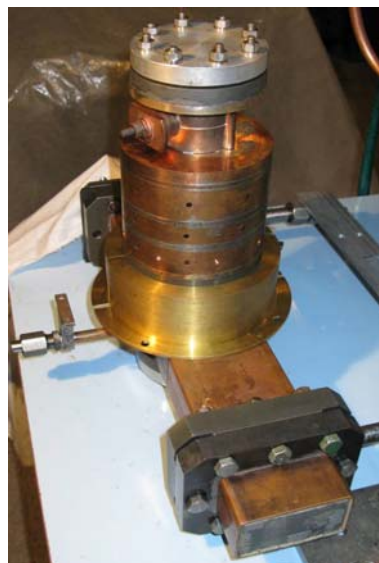
Рис.3. Группирующая система инжектора после пайки
