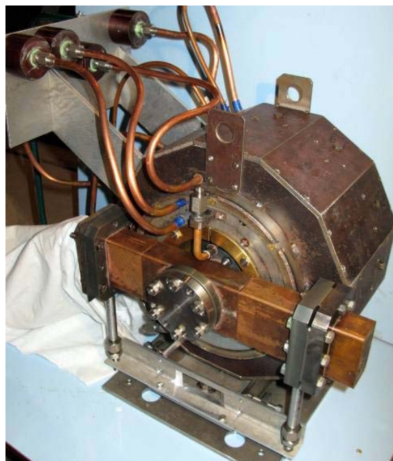
Рис. 7. Общий вид инжектора с соленоидом
