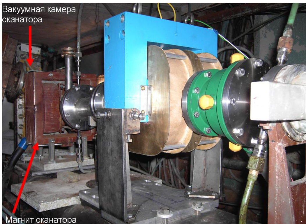
Рис.10. Система энергетического фильтра в бункере ускорителя «ЭПОС»
