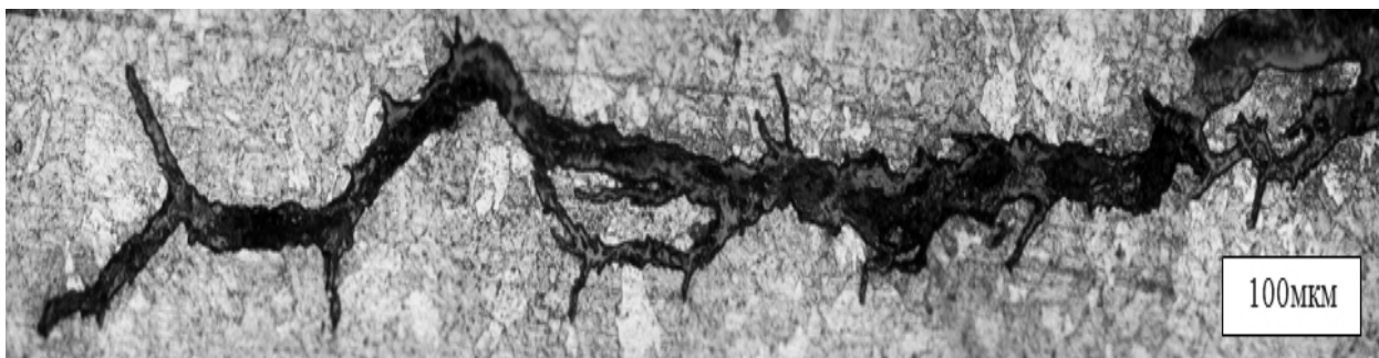
Рис. 3. Фрагмент трещины в сварном соединении №111, 2ПГ-1, ЗАЭС
