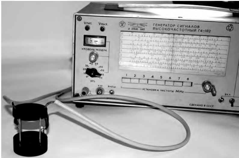
Рис. 1. Генератор и конденсатор лабораторной установки. Расстояние между обкладками конденсатора 2,5 см.
