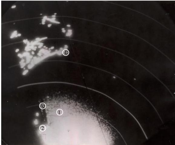
Рис. 8. Затенение отражений от морской поверхности за счет экранировки грядой гор  $H_{в}=90$  м: 1 – отражения от морской поверхности; 2 – гряда гор; 3 – затененный участок морской поверхности; 4 – отражения от мыса Чауда
