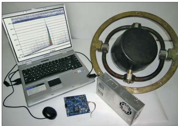
Рис. 9. Зовнішній вигляд мобільного апаратурно-програмного гідроакустичного комплексу дистанційного зондування газовиділень з морського дна у всьому діапазоні глибин Чорного моря [32]
