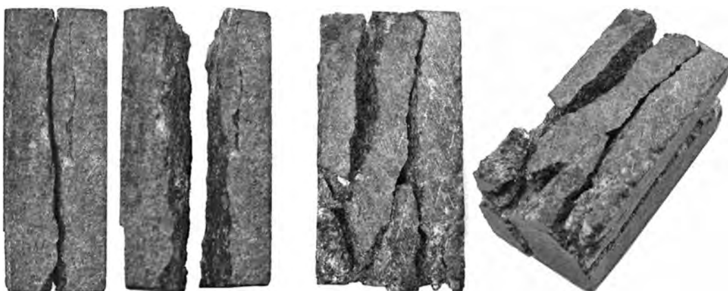
Рис. 2. Развитие трещин в образцах из ПЦМ размерами 55 \times 55 \times 20 мм с различными углами наклона \alpha начальных сквозных трещин при их осевом сжатии: a – \alpha = 0 , б – \pi/4
