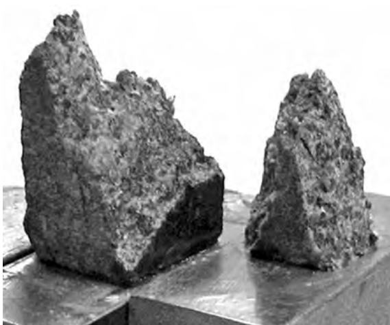
Рис. 3. Разрушение образцов из габбро при различных значениях коэффициента внешнего трения по стали k : a – 0.02, б – 0.11, в – 0.47 (приклеивание)
