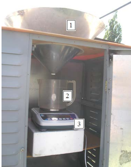
Рис. 9. Дождемер: 1 – воронка; 2 – сосуд; 3 – весы
