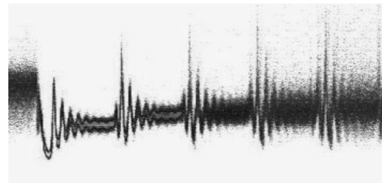
Рис. 8. Серия импульсов излучения, наблюдаемая в полупроводниковом лазере с задержкой оптической обратной связи [16]
