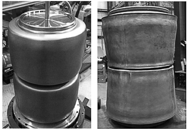
Рис. 7. Канистры емкостью 100 л, содержащие 170 кг отходов для иммобилизации в матрицу Synroc, до (а) и после ГИП-обработки (б)
