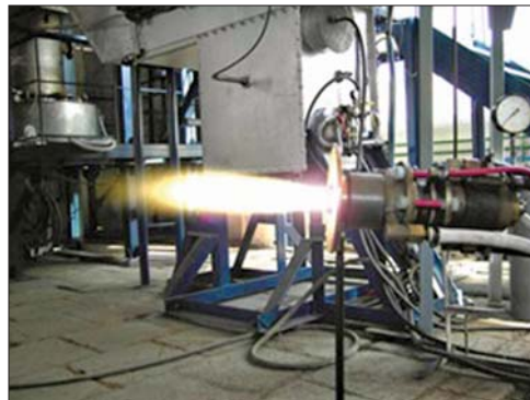
Рис. 6. Пароводяний плазмотрон для газифікації відходів (у тому числі небезпечних) з отриманням у результаті водню
