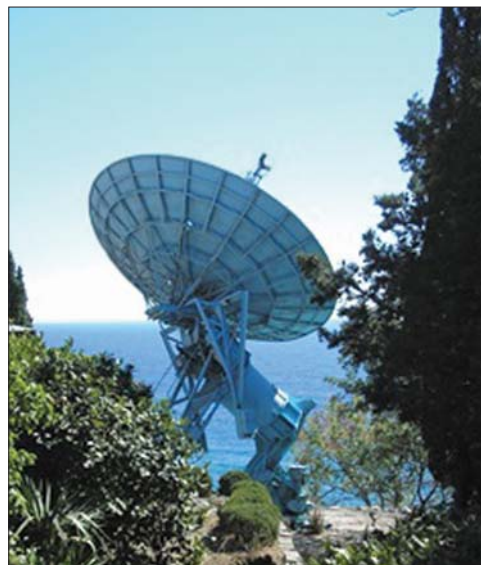
Рис. 2. Піч СТУ-7 для отримання водню з використанням концентрованого сонячного випромінювання
