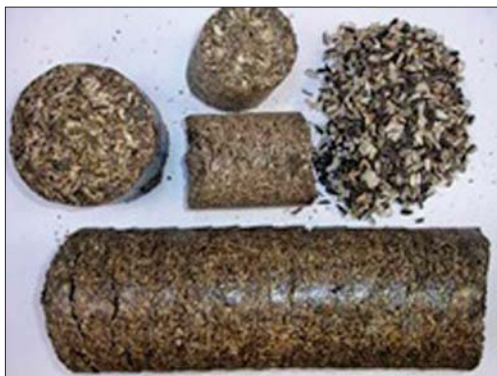
Рис. 4. Паливний брикет для отримання водню гетерогенно-каталітичною паровою конверсією. Брикет складається з відходів деревини, поліпропілену, гашеного вапна і нікелевого каталізатора
