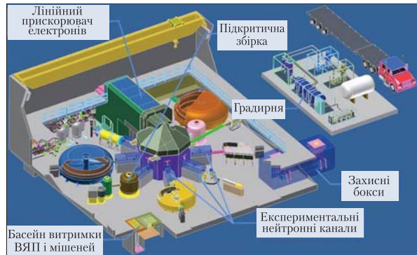
Загальний вигляд експериментального залу підкритичної ядерної установки «Джерело нейтронів»
