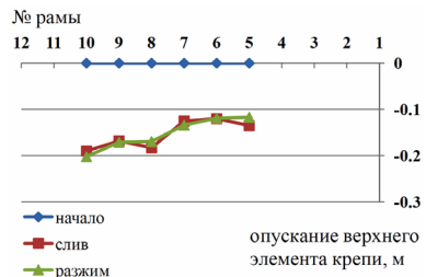
Рис. 6. Результаты наблюдений за топтаньем крепи сопряжения в условиях конвейерной выработки 11-й западной лавы
