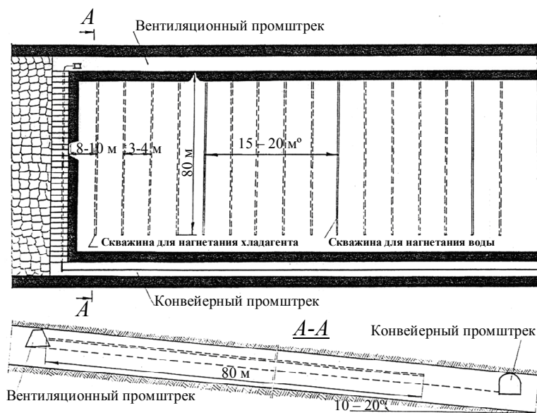
Рис. 2. Технология криогенного охлаждения пласта
