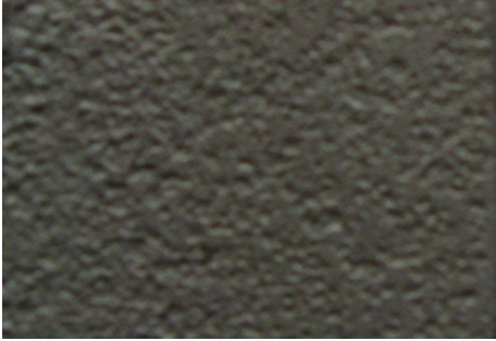
Рис. 15. Вигляд внутрішньої поверхні очищених труб діаметром 520 мм, експлуатованих протягом 45-ти років (а), та труб запасу (б)
