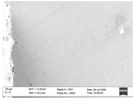
Рис. 16. Мікроструктура сталі 10Г2С з внутрішньої поверхні експлуатованої труби (а) та нетравлений шліф труби запасу з внутрішньої поверхні (б)
