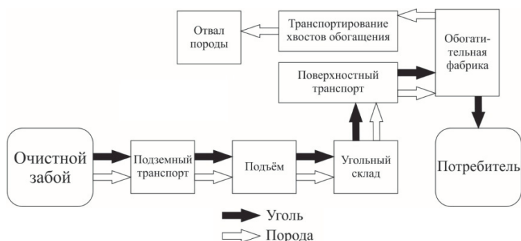
Рис. 4. Схема транспортирования угля и породы при традиционной технологии
