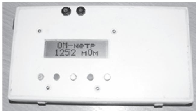
Рис. 6. Общий вид прибора для измерения сопротивления в зоне контакта отливки и стержня
