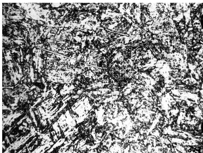
Рис. 3. Микроструктура стали кольца (×500)
