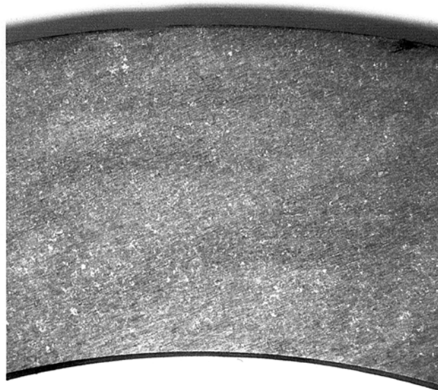
Рис. 2. Макроструктура стали кольца (×1)
