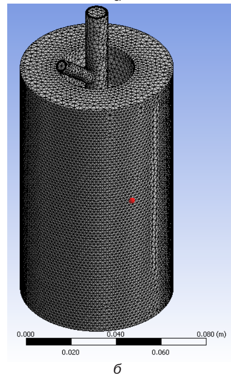
Рис. 2. Трехмерная модель проточной части и структура сетки расчетной области: фурма № 1 (а), фурма № 2 (б)
