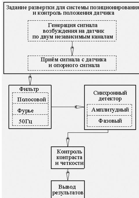
Рис. 2. Структурная схема программы управления и обработки сигнала
