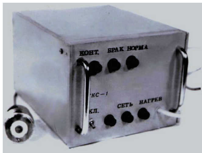
Рис. 5. Общий вид прибора для определения формы графита в изделиях из чугуна
