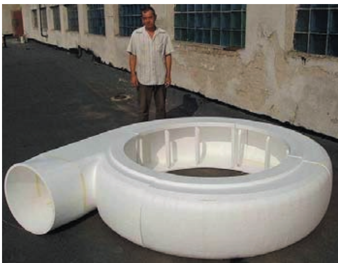
Рис. 6. Пенополистироловая модель отливки корпуса насоса (для перекачивания горнорудной пульпы) из износостойкой стали
