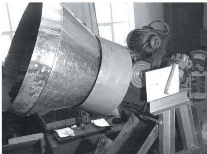
**Рис. 3.** Установка конусного барабанного окомкователя
