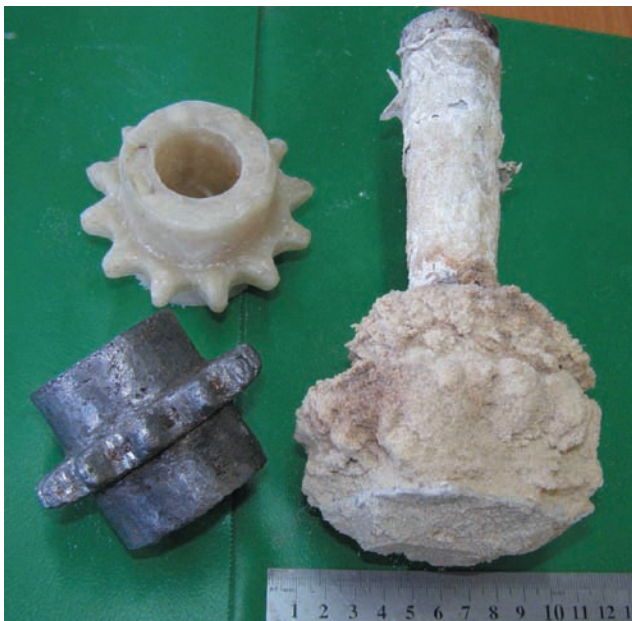
Рис. 4. Ледяная модель, отливка и оболочка (вид сбоку)
