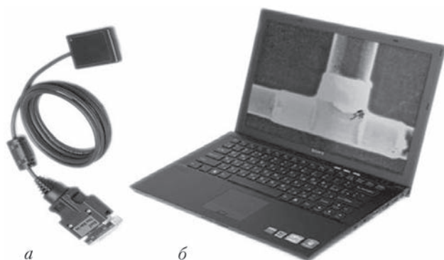
Рис. 3. Флэш-радиография с рентгеновской ПЗС матрицей фирмы «Hamamatsu Photonics»: а – ПЗС сенсор; б – рентгеновское изображение композитного тройника на экране ноутбука
