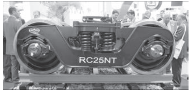
Рис. 8. Общий вид сварной конструкции тележки RC25NT
