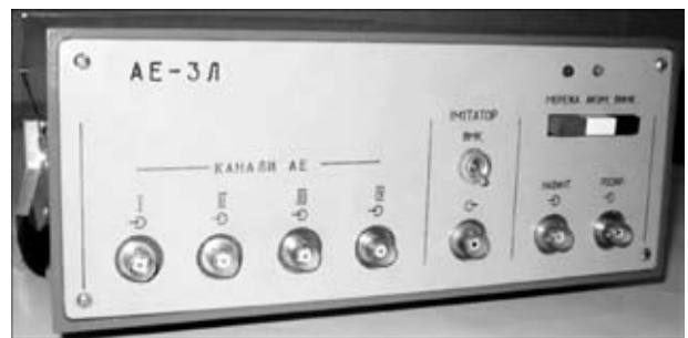
Рис. 8. Общий вид АЭ информационно-вычислительной системы АЭ-3Л
