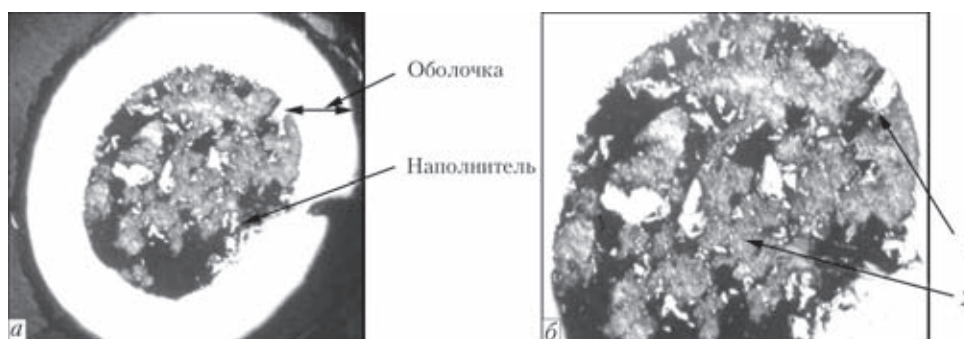
Рис. 1. Микроструктура ( \times 50 ) поперечного сечения проволоки (а) и микроструктура ( \times 100 ) и состав наполнителя (б) (1 — 16,6 Fe; 82,8 Cr; 0,36 Al; 0,2 Mn; 2 — 0,36 Fe; 0,2 Cr; 99,67 Al; 0,07 Mn)
