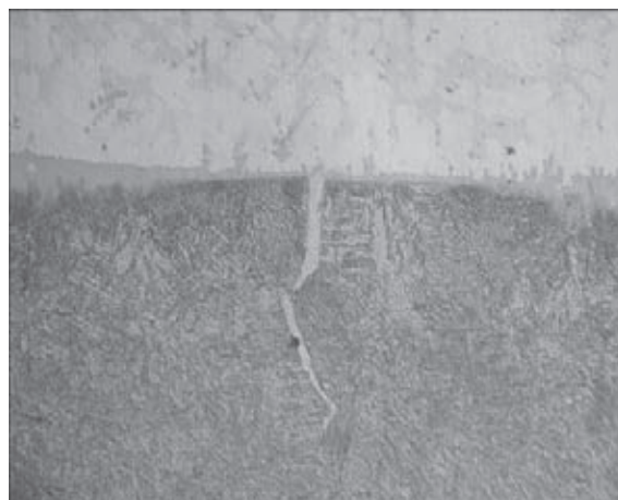
Микроструктура (x100) зоны сплавления оловянной бронзы со сталью (трещина заполнена бронзой)
