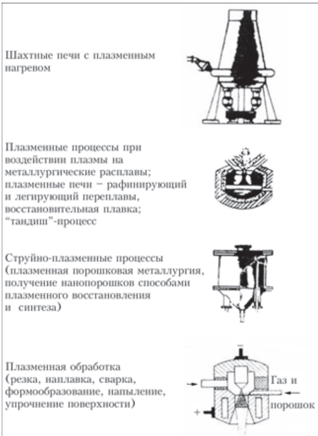
Рис. 1. Аппаратурно-технологическая классификация плазменных процессов в металлургии и при обработке материалов
