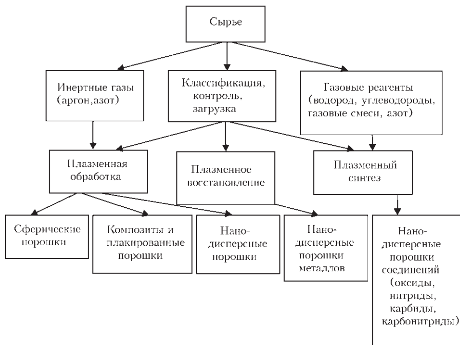
Рис. 4. Схема плазменной технологии производства порошков
