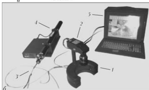
Рис. 6. Спекл-интерферометрическая измерительная система: а — оптическая схема спекл-интерферометра; б — общий вид спекл-интерферометрической измерительной системы
