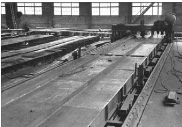
Рис. 3. Процесс сборки ферм в кондукторе
