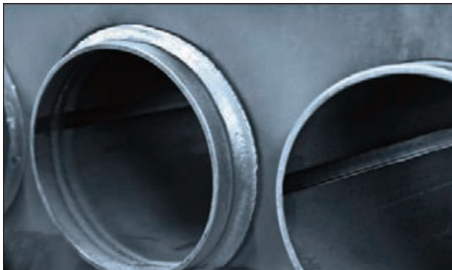
Рис. 3. Пример сварного шва, полученного с помощью сварочной системы FTW 24-120 Pro
