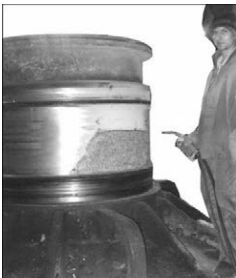
Рис. 1. Наплавка цапфы мельницы сварочным полуавтоматом и эскиз цапфы
