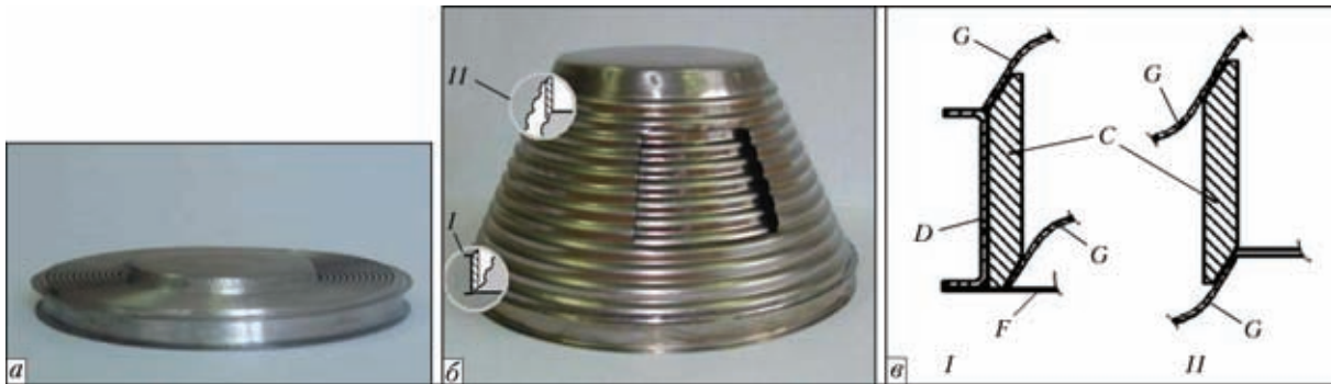
Рис. 15. Модель двухстенчатой преобразуемой конической оболочки (материал — титан ВТ1-0, толщина 0,15 мм): a — компактное состояние; b — развернутое состояние; в — осевые сечения несущих элементов (шпангоутов) I и II ; C , D — несущий и вспомогательный шпангоуты; F — днище оболочки; G — преобразуемые конические оболочки
