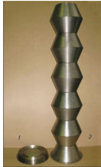
Рис. 2. КПО периодического профиля (материал — титан ВТ1-0, толщина 0,15 мм), состоящая из 11 базовых конических оболочек [2]: 1 — конструкция в компактном сложенном состоянии; 2 — конструкция после раскрытия
