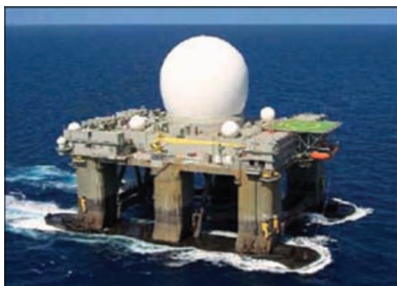
Рис. 6. Воздухоопорная конструкция антенного обтекателя на испытательной платформе ILC Dover в Мексиканском заливе [6]
