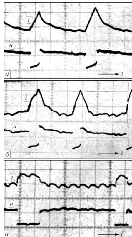
Рис. 1. Осциллограммы тока и напряжения при ограничении тока короткого замыкания дросселем (а), наклоном внешней характеристики сварочного выпрямителя, трансформатор которого имеет развитое рассеяние (б) и резистором (в) [2]
