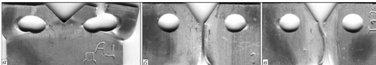
Рис. 2. Внешний вид разрушенных образцов основного материала (а) и сварных соединений сплава АМцН, полученных способом АДСНЭ (б) и СТП (в)
