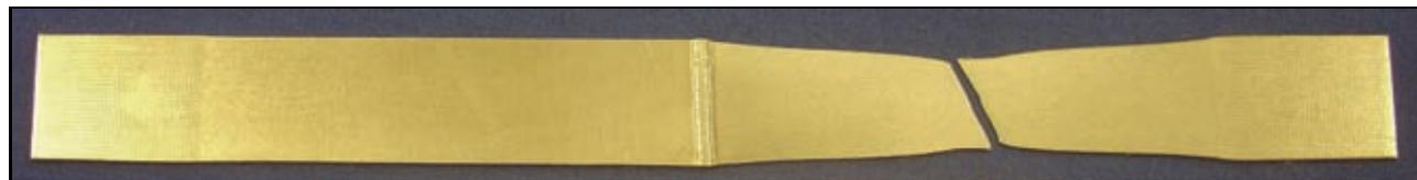
Соединение стали (слева) с алюминием (справа) — пайка стали и сварка алюминия
