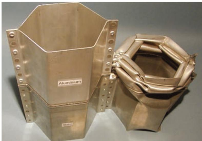
Испытания образцов, выполненных с помощью сварки-пайки СМТ, демонстрируют впечатляющие результаты
