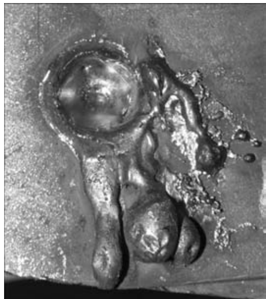
Рис. 1. Некачественно сформированная сварная точка вследствие стекания расплавленного металла по вертикальной плоскости
