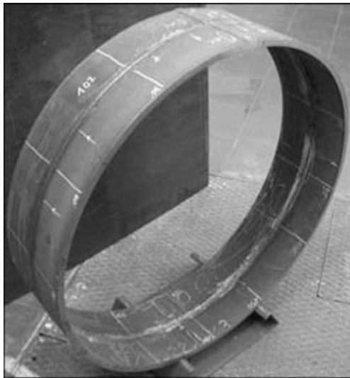
Рис. 6. Образец, выполненный полуорбитальной гибридной сваркой
