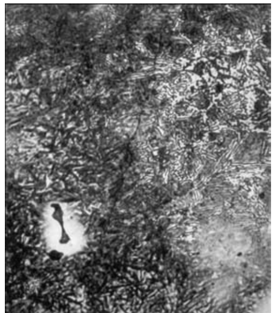
Рис. 1. Микроструктура наплавленного металла (X600) при содержании кремния 0,58 %
