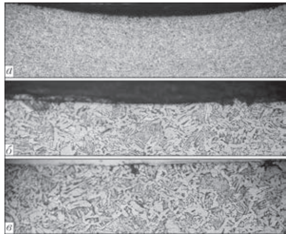
Рис. 6. Микроструктура стали Ст3 после ЭДО с прокладкой из меди М1 толщиной 0,5 мм: а — общий вид «лунки» ( \times 50 ); б — центр «лунки» ( \times 200 ); в — Ст3 в исходном состоянии ( \times 200 )
