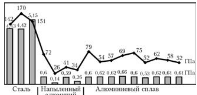
Рис. 7. Диаграммы распределения микротвердости по Мейеру (столбики) и модуля упругости Юнга (кривая)
