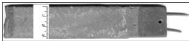
Рис. 7. Вид оплавленного торца закладного электрода при электродуговой сварке металла толщиной 30 мм (толщина металлической части электрода — 6 мм, покрытия — 1,2 мм)
